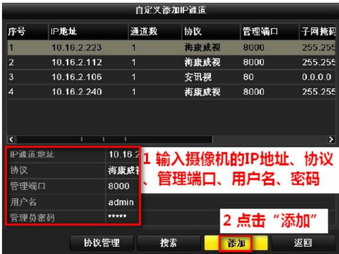
【注意】请及时关注通道栏的“状态”，如果出现黄色三角感叹号，可点击查看错误，根据错误提示修改参数，用自定义添加方式添加摄像机。
